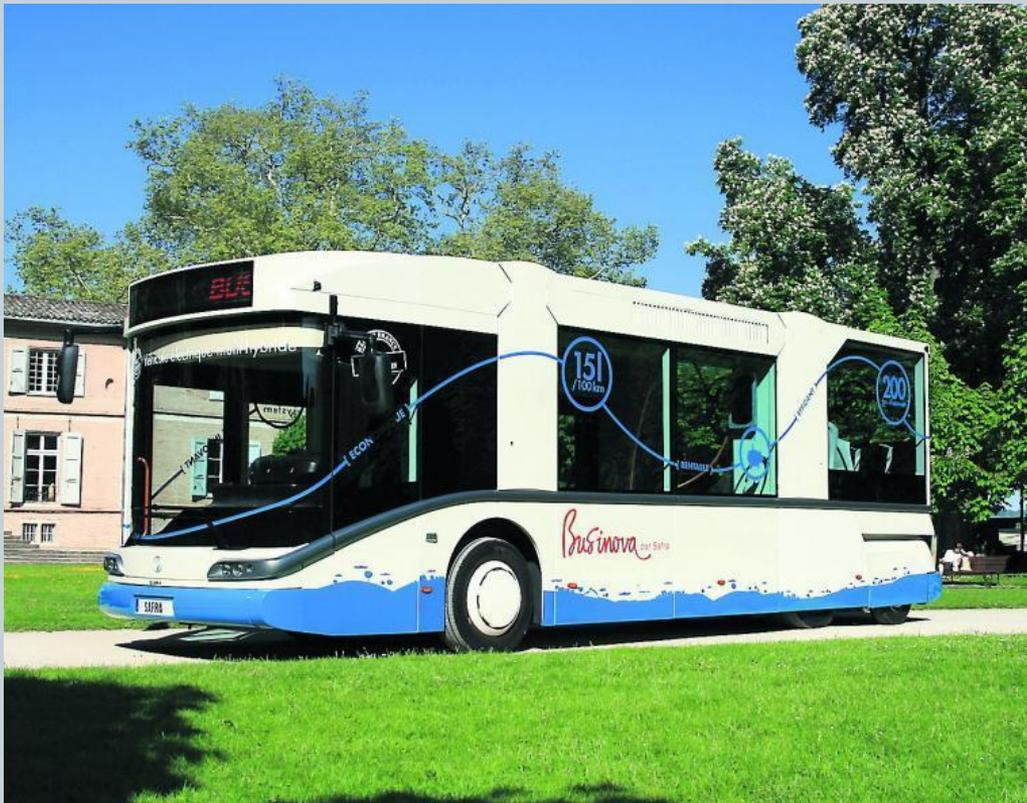
Ce véhicule a reçu le trophée de l'innovation le dix juin dernier à Paris. Son système breveté de motorisation comprend trois sources d'énergie: électrique, hydraulique, thermique. Il est économe, propre (rejette moins de CO<sub>2</sub>) et facile d'accès.
